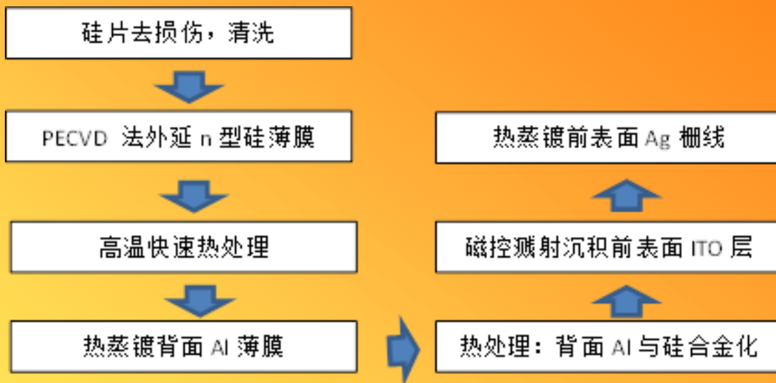
低温外延制结晶硅太阳能电池结构图(a)和本课题组所采用技术路线示意图(b)
